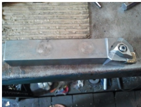
Fig.3 Carbide tool CNMG 12 04 04
